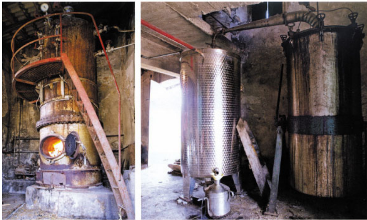
Slika 4. Uređaj za destilaciju ružmarina vodenom parom: parni kotao, kotao za ružmarin i hladnjak (snimio Davor Petrić 2011.).
