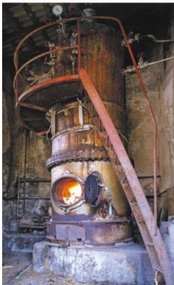
Slika 4. Uređaj za destilaciju ružmarina vodenom parom: parni kotao, kotao za ružmarin i hladnjak (snimio Davor Petrić 2011.).
