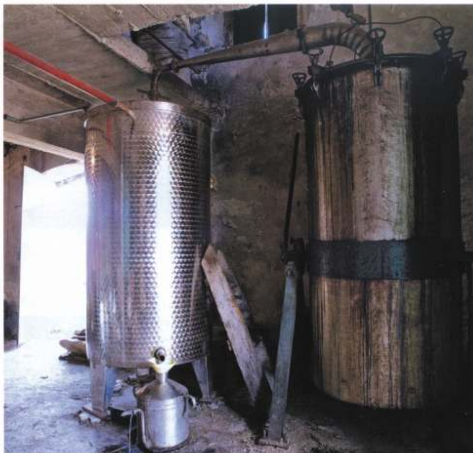
Slika 4. Uređaj za destilaciju ružmarina vodenom parom: parni kotao, kotao za ružmarin i hladnjak (snimio Davor Petrić 2011.).
